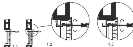
**1.1** Girar el tornillo mediante destornillador. El primer cuarto de vuelta la lengüeta del pestillo se coloca detrás del marco metálico.
