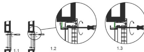
**1.1** Girar el tornillo mediante destornillador. El primer cuarto de vuelta la lengüeta del pestillo se coloca detrás del marco metálico.
