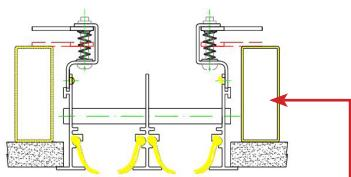
Los fijadores están adheridos a la cara interior del plenum. Posteriormente se atornillan los 4 pestillos para que su lengüeta haga tope con los TAC50X20, fijando así el difusor lineal.
