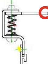
El plenum contiene dos perforaciones laterales para fijar la rejilla Ref. REGEHV300x150BL mediante los dos pestillos que dispone esta.
