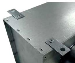
Los fijadores están adheridos a la cara interior del plenum. Posteriormente se atornillan los 4 pestillos para que su lengüeta haga tope con los TAC50X20, fijando así el difusor lineal.
