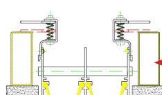
**TAC50X20:** Fijadores del difusor al plenum, no incluidos en el precio y necesarios para su fijación al plenum o al falso techo. Es necesario uno por cada pestillo. Los fijadores se adhieren a la cara interior del falso techo mediante el adhesivo incorporado. Posteriormente se atornillan los 4 pestillos para que su lengüeta haga tope con los TAC50X20, fijando así el difusor lineal.
