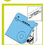
1. Presionar el clip y tire de la sección superior de la sección inferior. Cuando no coloque el dispositivo en una caja de pared empotrada o cuando el material de la pared necesite preparación, use la placa de montaje como plantilla.
